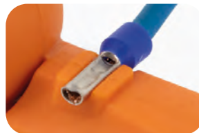
Ponteira de 1.5mm 2 cravada com F30
